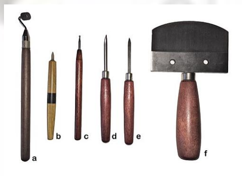
7. Outils de gravure : a. roulette ; b. agate ; c. brunissoir boule ; d. brunissoir ; e. grattoir ; f. berceau.
